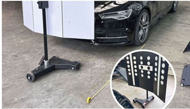
Abbildung 6: Mangelhafter Aufbau zur Kalibrierung der Frontkamera [30]
