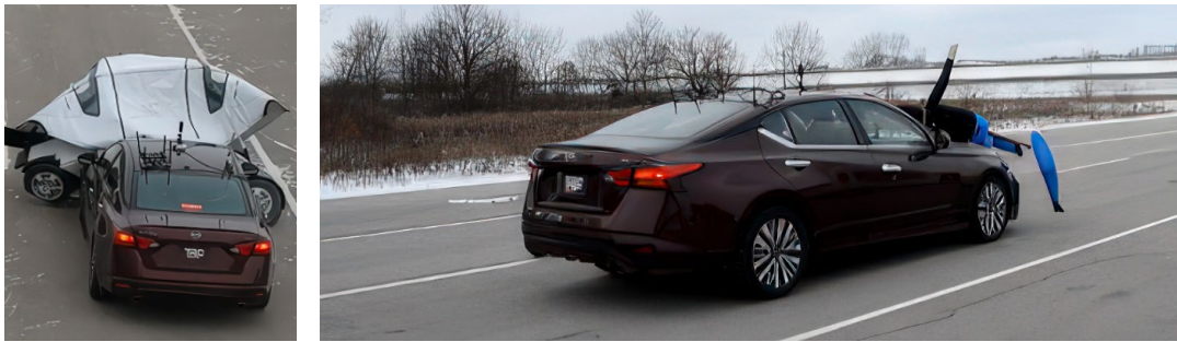
Abbildung 4: Fahrzeug kollidiert ungebremst mit Fahrzeugtarget (Sensoren verstellt, fehlende Kalibrierung), links; Fahrzeug kollidiert mit Fußgängerdummy, (Ist-Zustand nach 12.900 Meilen, Kollision wurde nach Kalibrierung vermieden), rechts [18]
